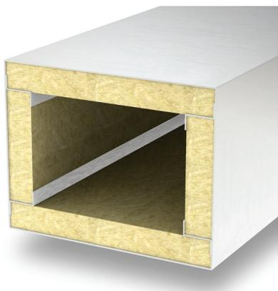
*Для уменьшения уровня шума, переносимого воздушными потоками, эффективно применяются плиты PAROC InVent с покрытием, которые устанавливаются внутри воздуховодов. Все стыки должны быть закрыты металлическим профилем.*
