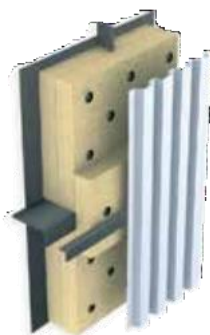
Стенка корпуса электрофильтра
