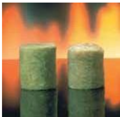
Слева образец каменной ваты до испытания на огнестойкость, справа - после испытания.
