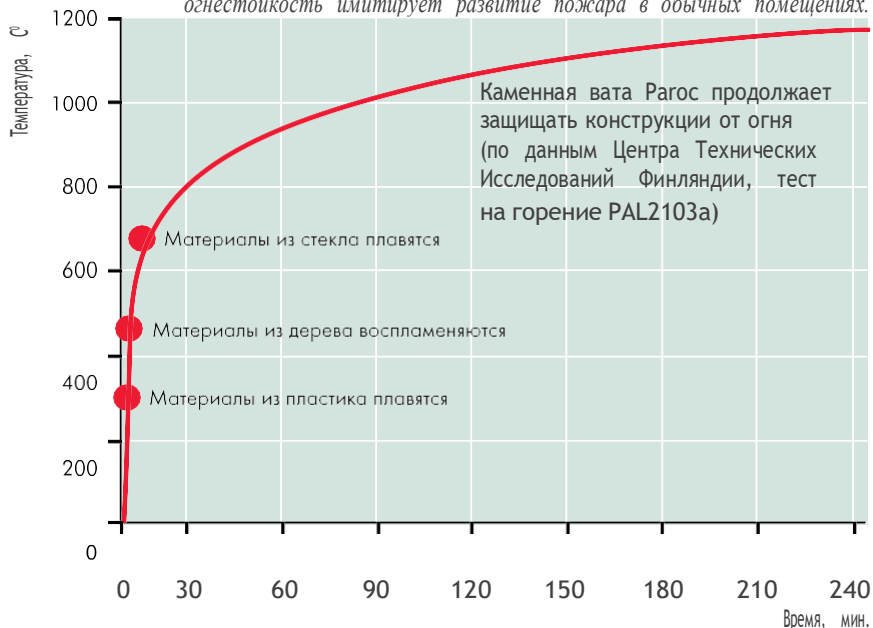
График 1. Поведение некоторых строительных материалов в огне. Испытание на огнестойкость имитирует развитие пожара в обычных помещениях.
