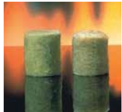
Слева образец каменной ваты до испытания на горючесть, справа - после испытания.
